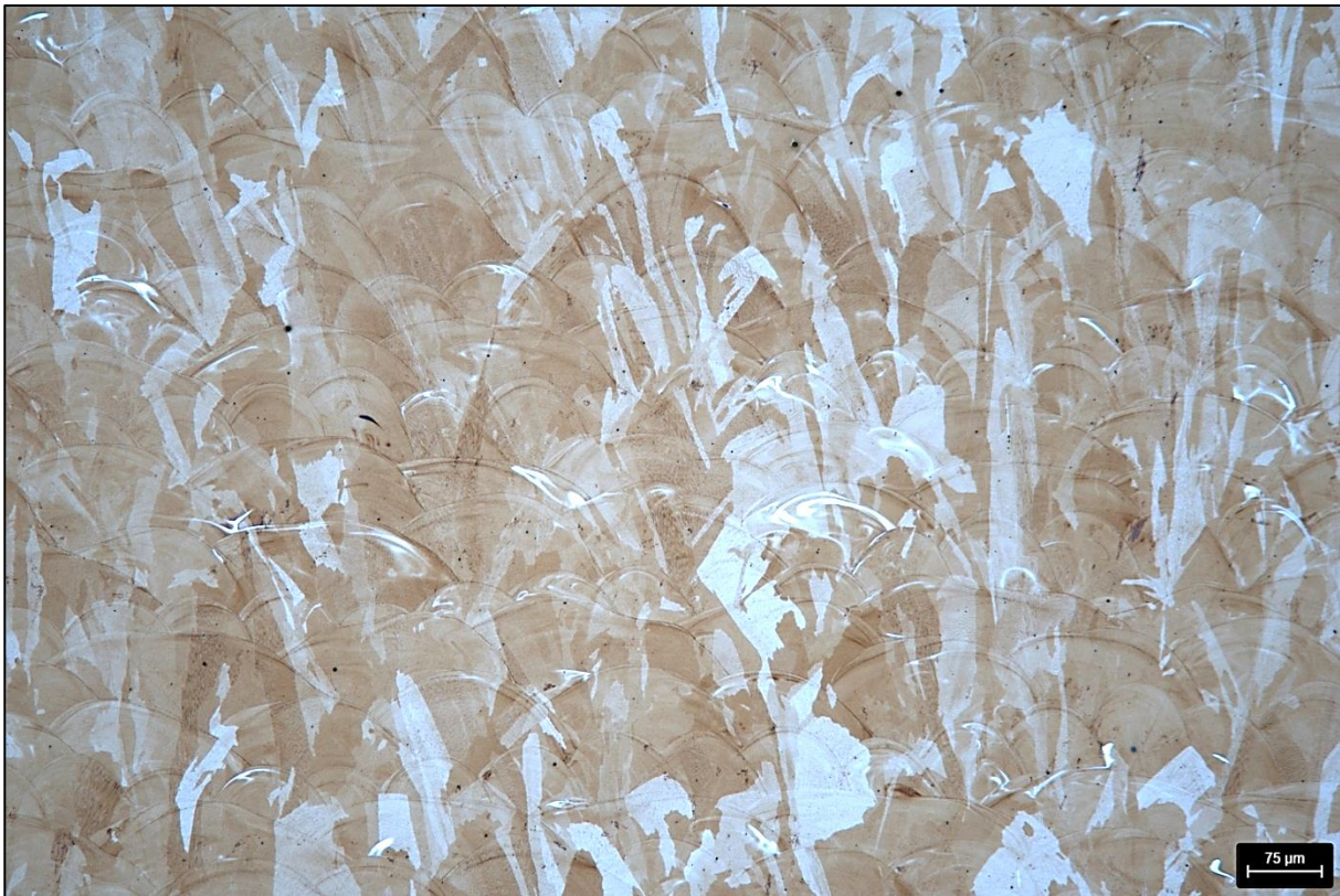
Bild 18: CoCrMo – Probe 2 – angeätzt mit Beraha 3 – 100 x
