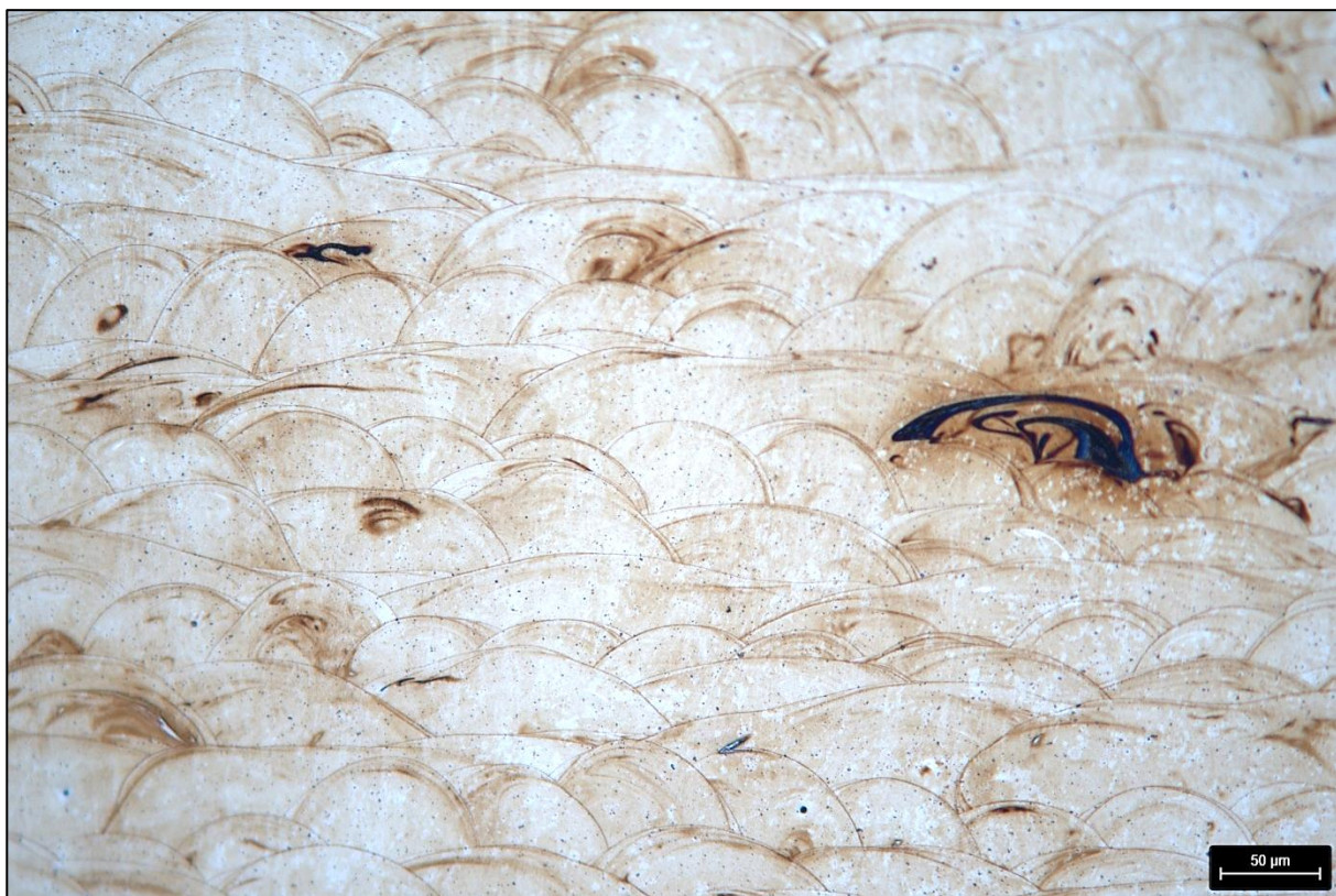
Bild 15: CoCrWMo – Segment 5Ü – angeätzt mit Beraha 3 – 200 x
