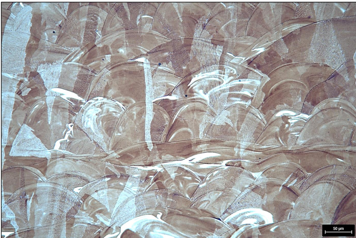
Bild 17: CoCrMo – Probe 1 – angeätzt mit Beraha 3 – 200 x
