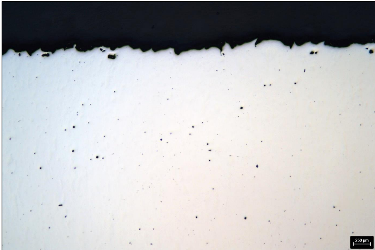
Bild 8: CoCrWMo – Segment 5 – ungeätzt – 25 x
