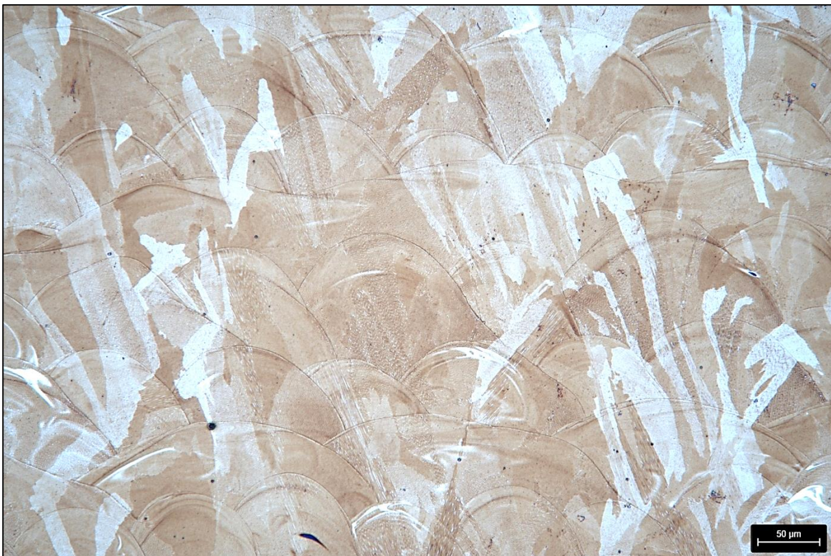
Bild 19: CoCrMo – Probe 2 – angeätzt mit Beraha 3 – 200 x
