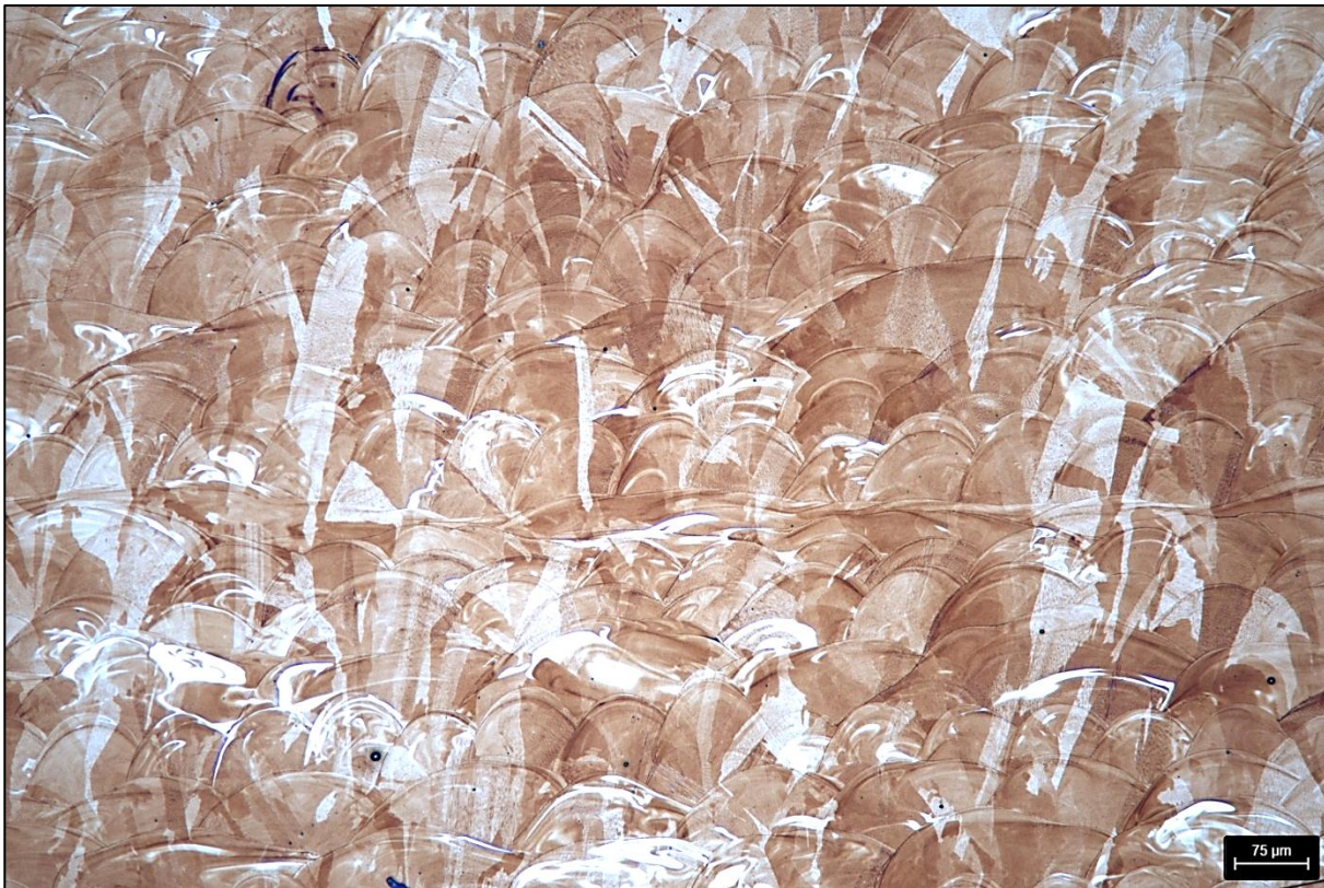
Bild 16: CoCrMo – Probe 1 – angeätzt mit Beraha 3 – 100 x
