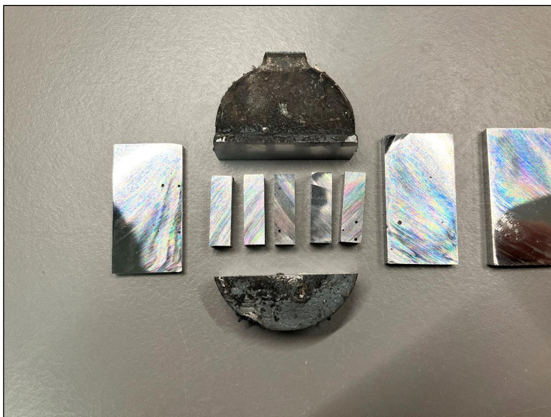
Bild 9: Probenvorbereitung Option 1 – Getrennte Probe.
