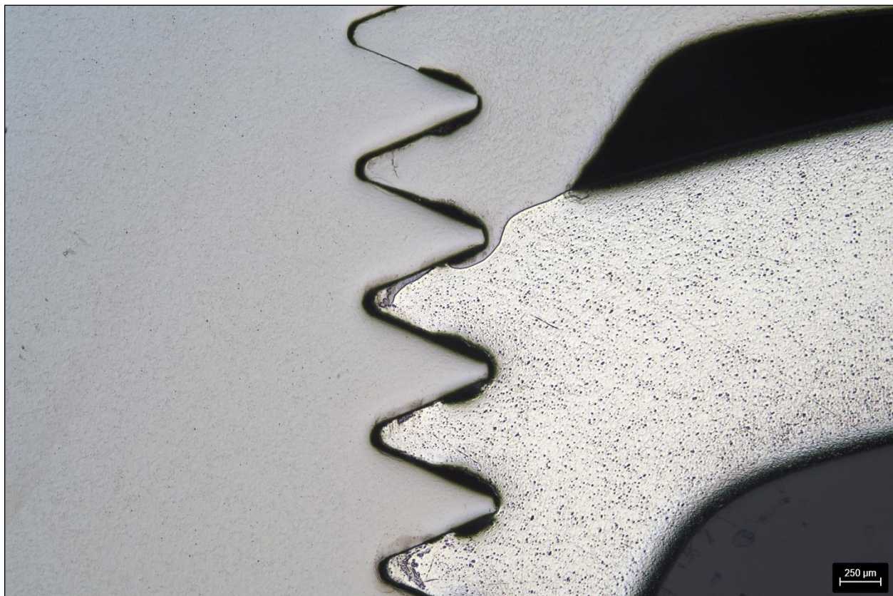
Abb. 14: Probe NP2 – Nietverbindung – nach Omega 0,05 µm ungeätzt – 25 x
