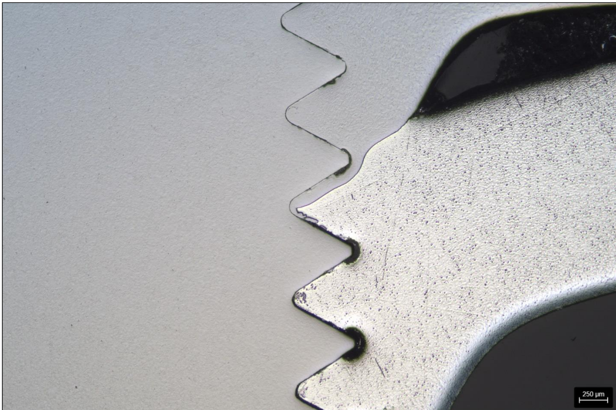
Abb. 12: Probe NP1 – Nietverbindung – nach Omega 0,05 µm ungeätzt – 25 x
