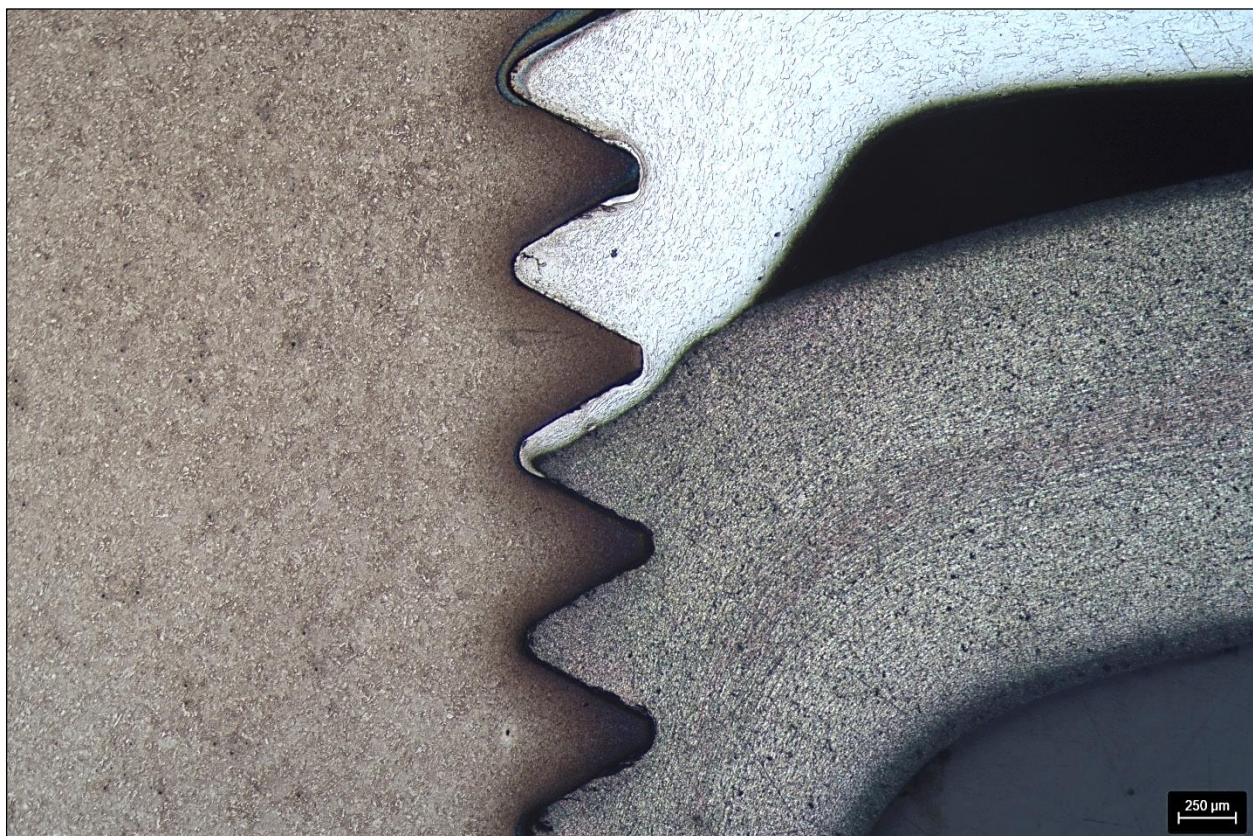
Abb. 17: Probe NP3 – Nietverbindung – nach Omega 0,05 µm, Ätzung 1 und Ätzung 2 – 25 x
