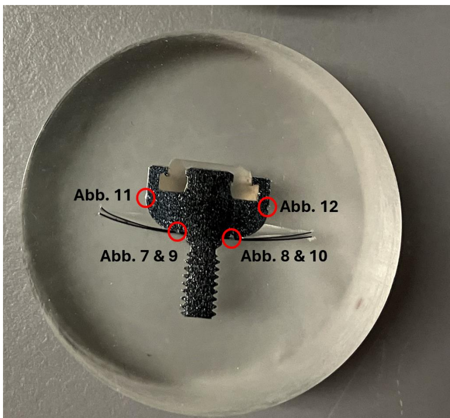
Abb. 6: Die eingebettete Probe mit Markierung der untersuchten Regionen.
