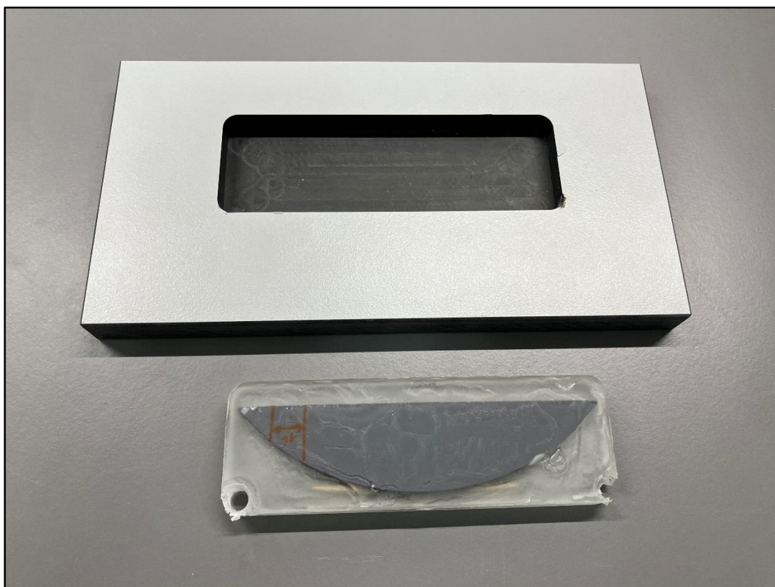
Abb. 3: Siliziumprobe nach der Kalteinbettung mit KEM 20.
