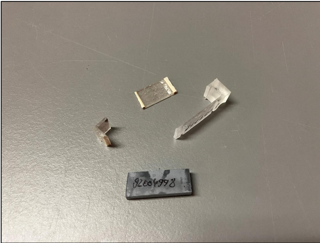
Abb. 8: Siliziumprobe nach Trennversuch mit Trennscheibe 92004998 und anschließend aus dem KEM 20 ausgebrochen.
