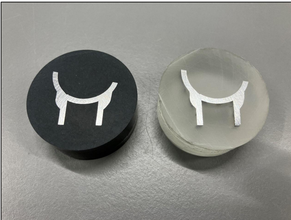
Abb. 4: links: Probe 1 nach Einbettung mit Qpress 50 (Warmeinbettung) rechts: Probe 1 nach Einbettung mit Qmount und KEM 50 UV (UV-Einbettung)
