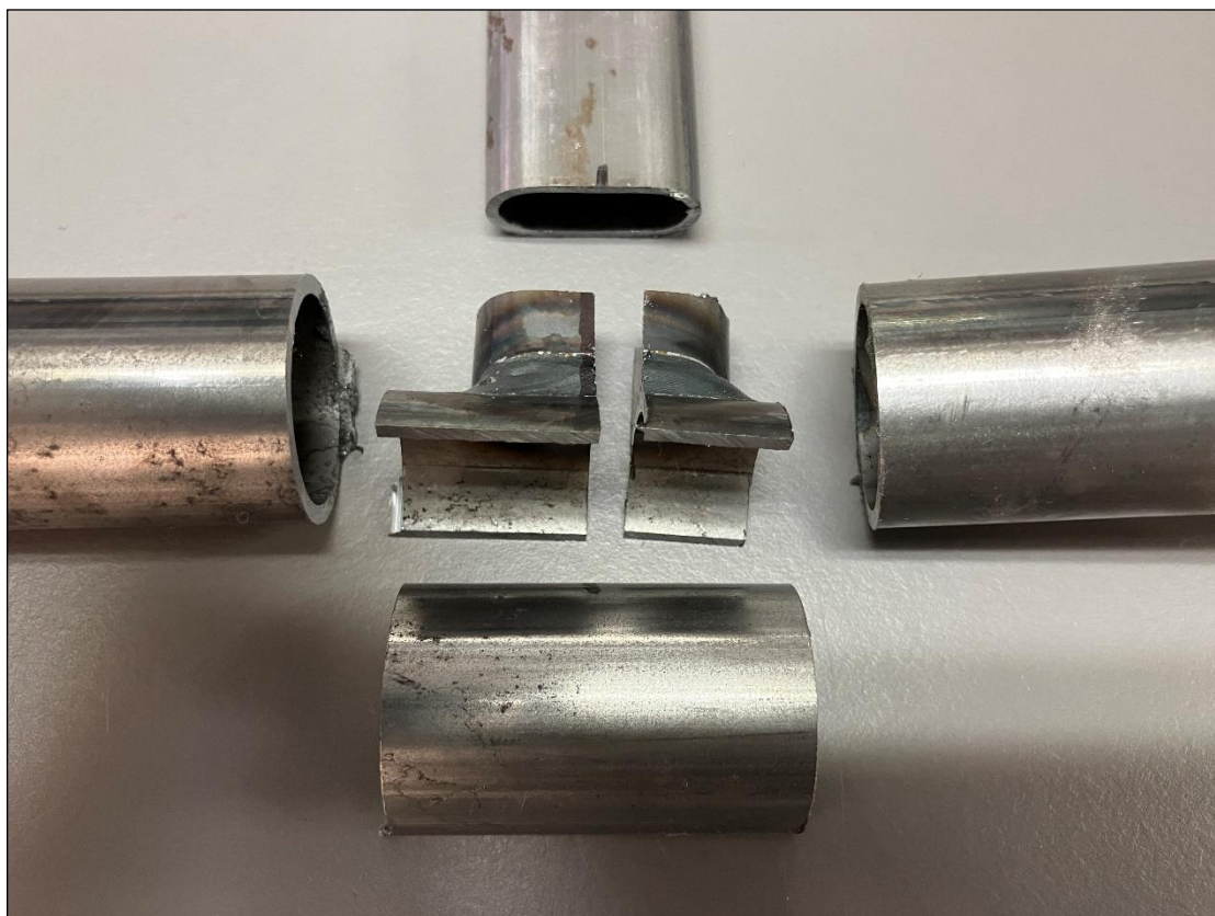
Abb. 6: Ein- oder beidseitig geschweißter Bügel nach allen Schnitten.
