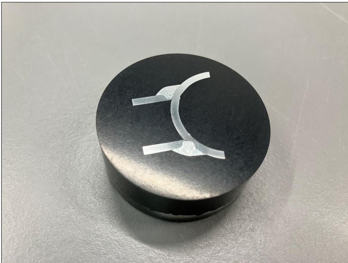
Abb. 11: Beidseitig geschweißter Bügel nach Qpress 50 - SIGMA 3 µm und Salpetersäure.
