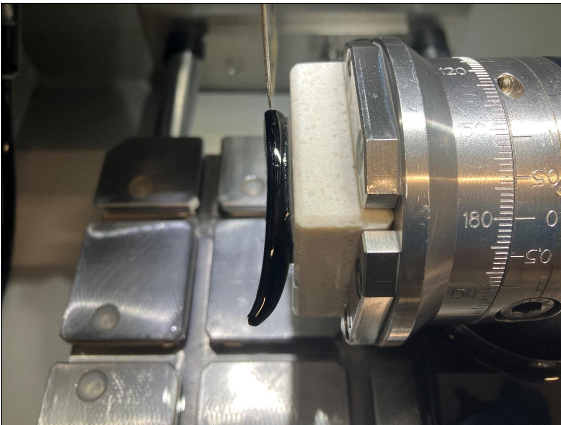
Abb. 20: Spannsituation der Probe vor dem Schnitt 4 und 5.
