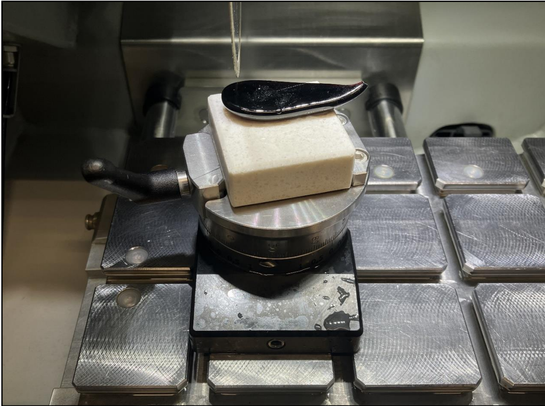
Abb. 15: Spannsituation der Probe vor dem Schnitt 1.
