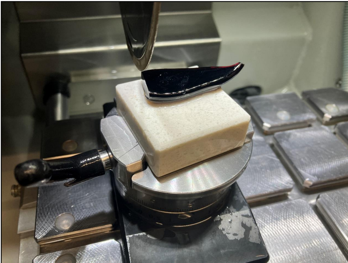
Abb. 16: Spannsituation der Probe nach dem Schnitt 1.
