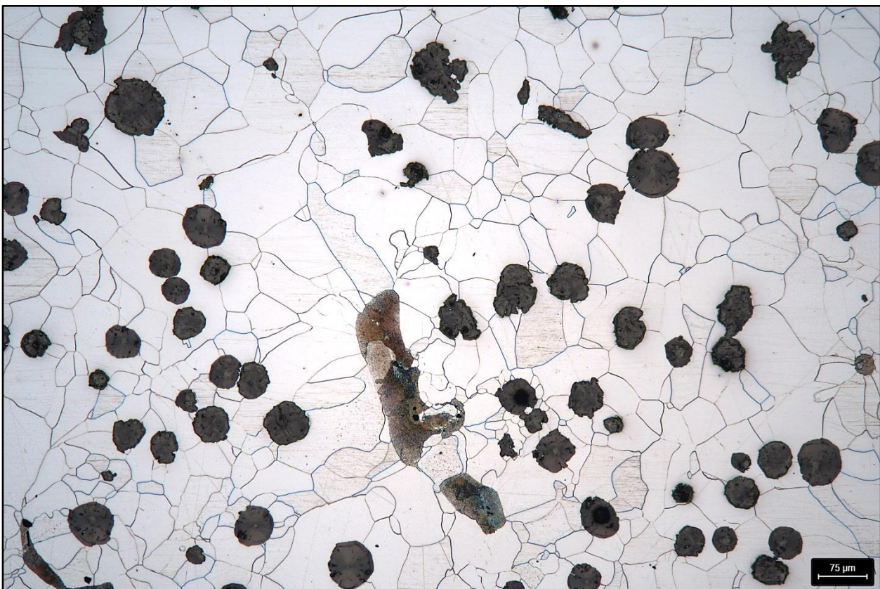
Abb. 5. Rechteckprobe nach Methode 1 – geätzt mit 3%ger alk. Salpetersäure – 100 x
