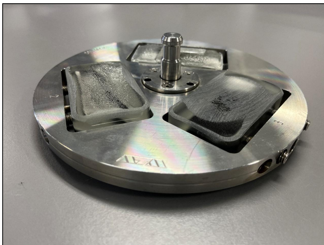
Abb. 2. Probenhalter Empfehlung für eingebettete Proben.
