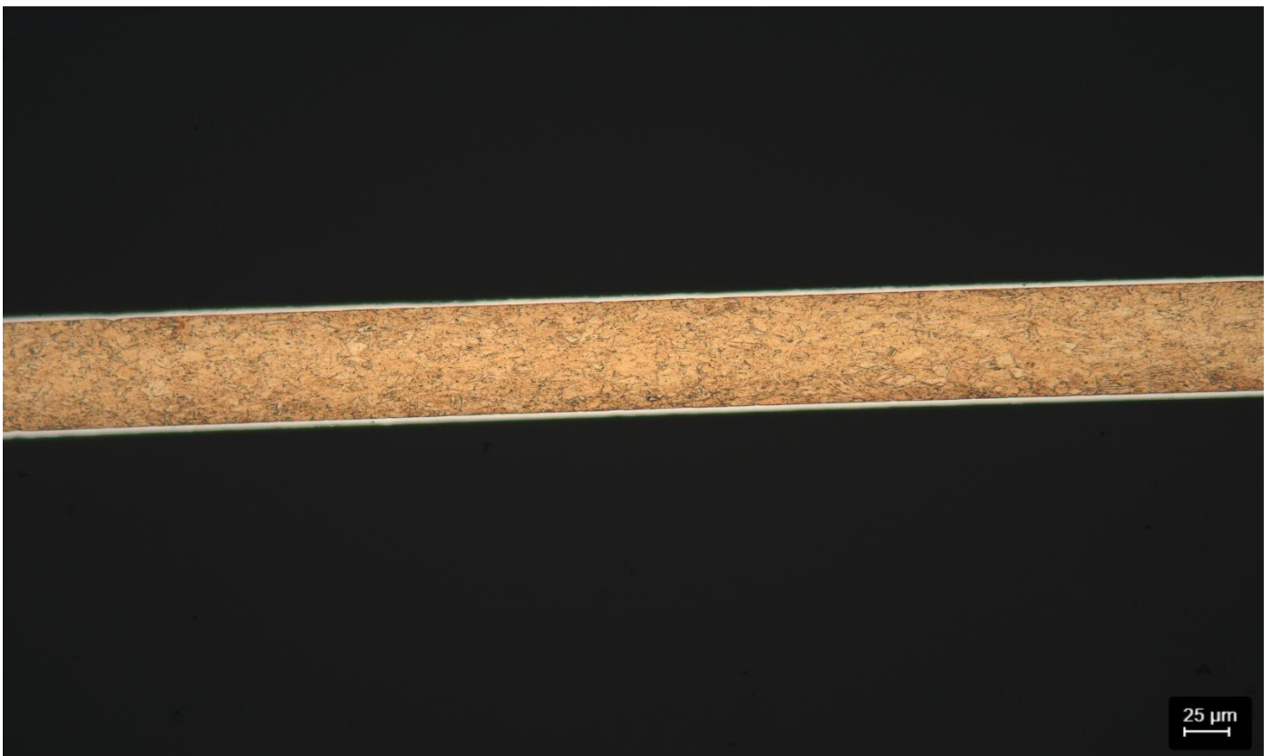
Abb. 6. Das Gefüge + Silberschicht nach dem Ätzen – 200 : 1
