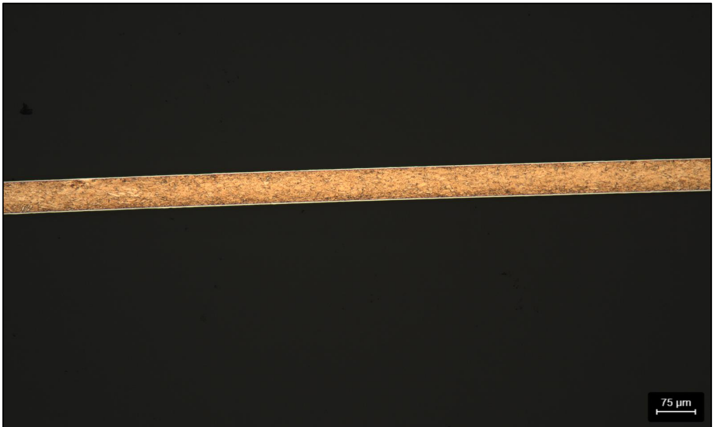
Abb. 5. Das Gefüge + Silberschicht nach dem Ätzen – 100 : 1
