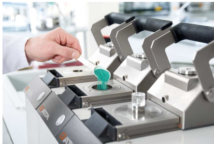
1. Einfüllen von geeignetem Einbettmittel in die Pressform
