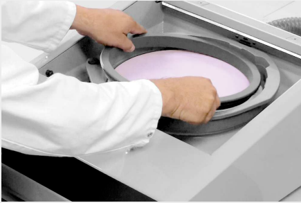
Einsetzen der Polierwanne
