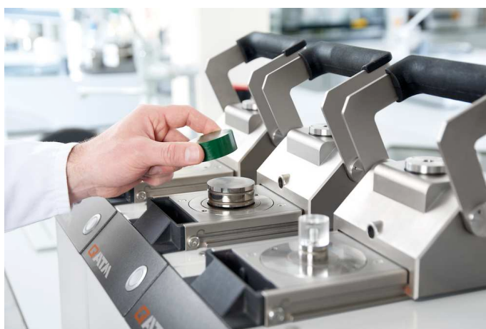
4. Démarrage de la méthode d'enrobage automatisée par le bouton multifonctions
