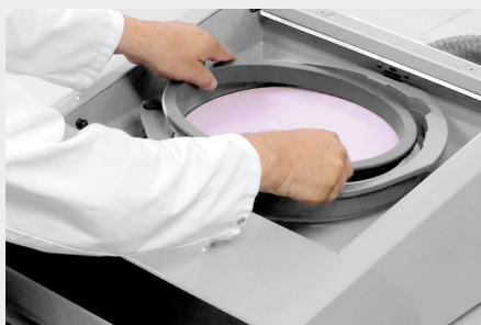
Mise en place du bac de polissage
