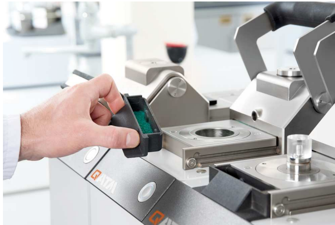
3. 余分な埋込材が自動的に押し込まれるので、ダストトラップがきれいになる
