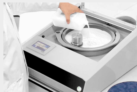
Preenchendo a suspensão
