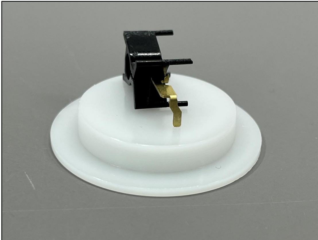
Abb. 10. Einrichtung der Probe 7 B in das Einbettförmchen
