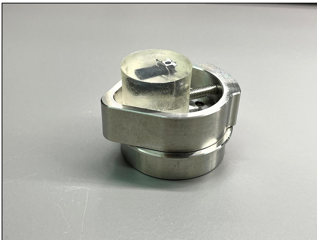
Abb. 12. Spannen der Probe im Tropfenformspanner
