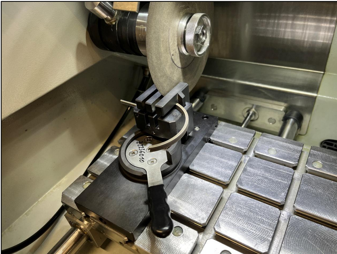
Abb. 3. Proben eingerichtet für den Trennschnitt.
